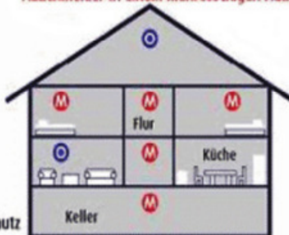
Abbildung 1: Die Zeichnungen zeigen die Ausstattung einer Dreizimmerwohnung und eines mehrstöckigen Wohnhauses. Dargestellt ist der gesetzliche Mindestschutz (M) sowie die für den optimalen Schutz notwendige Bestückung (O).
