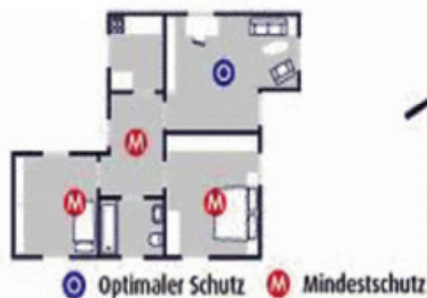
Abbildung 1: Die Zeichnungen zeigen die Ausstattung einer Dreizimmerwohnung und eines mehrstöckigen Wohnhauses. Dargestellt ist der gesetzliche Mindestschutz (M) sowie die für den optimalen Schutz notwendige Bestückung (O).
