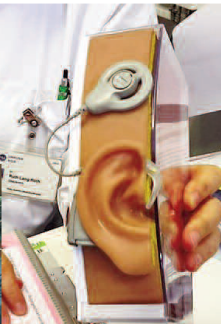
Der magnetische Sprachprozessor hinter dem Ohr. Er versorgt das Implantat auch mit Strom.
