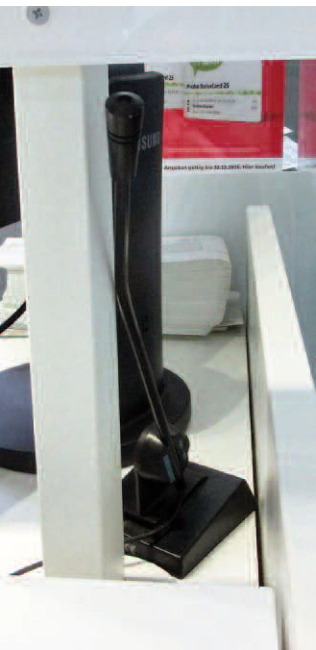
Die Induktionsanlage am Tisch der DB-Mitarbeiterin.
